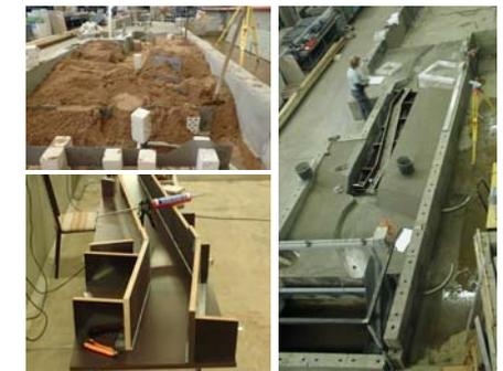
Aufbau des Modells: Links oben: Einsanden der Geländeprofile, links unten: Aufbau des Bauwerks, rechts: fertig betoniertes Modell mit eingebautem Bauwerk
